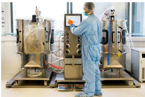
Première étape : **on va cultiver les « cellules-usines » dans des bio-réacteurs** dont la contenance va, aujourd'hui, jusqu'à 200 litres et dans lesquelles les cellules se multiplient dans un liquide nutritif spécifique (« milieu de culture »).
